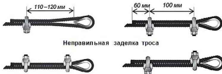
Рисунок 6 – Заделка троса
